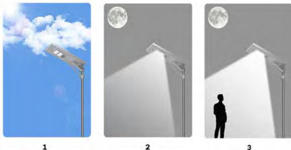
Figura 5: Funcionamento de luminária solar autônoma
