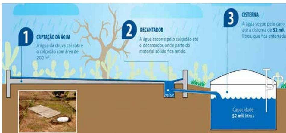
Figura 15: Ilustração de um sistema de cisterna-calçadão
