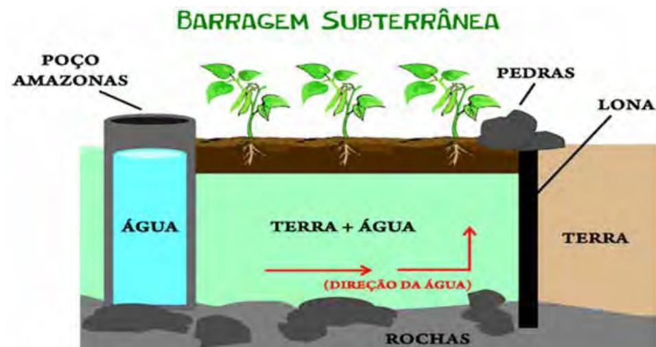
Figura 16: Ilustração de um sistema de barragem subterrânea
